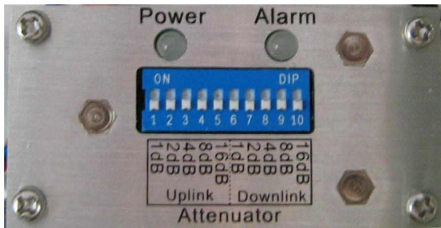
Малогабаритные DIP переключатели аттенюатора UPLINK и DOWNLINK позволяют регулировать (в сторону уменьшения) коэффициент усиления ретранслятора раздельно в прямом и обратном направлении в диапазоне 31 дБ с шагом 1 дБ. Чтобы изменить вносимое затухание аттенюатора, необходимо перевести
